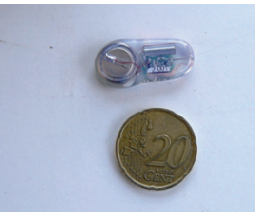
Fotografías n.º 5, 6 y 7. Emisor utilizado para el seguimiento de truchas mediante radiotracking, colocación del emisor en un ejemplar de trucha por técnicos de la consultora EKOLUR y cierre mediante puntos de sutura de la incisión practicada para su colocación (Autor: J.M.)
