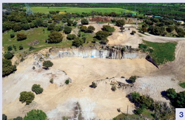
Fig. 6. (1): cantera antes de su restauración. (2): diseño por ordenador (CAD) del paisaje de restauración. (3): resultado tras el remodelado geomorfológico
