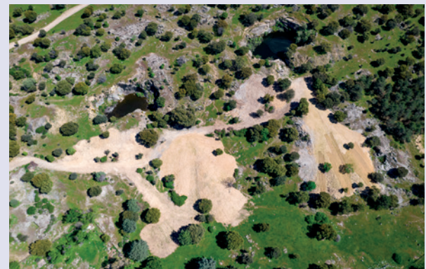
Fig. 8. Arriba: escombrera con anterioridad a la restauración. Abajo: aspecto tras el remodelado topográfico, extendido de suelos y revegetación. Este espacio representa un caso de restauración únicamente de escombreras, y en posiciones exteriores a los huecos
