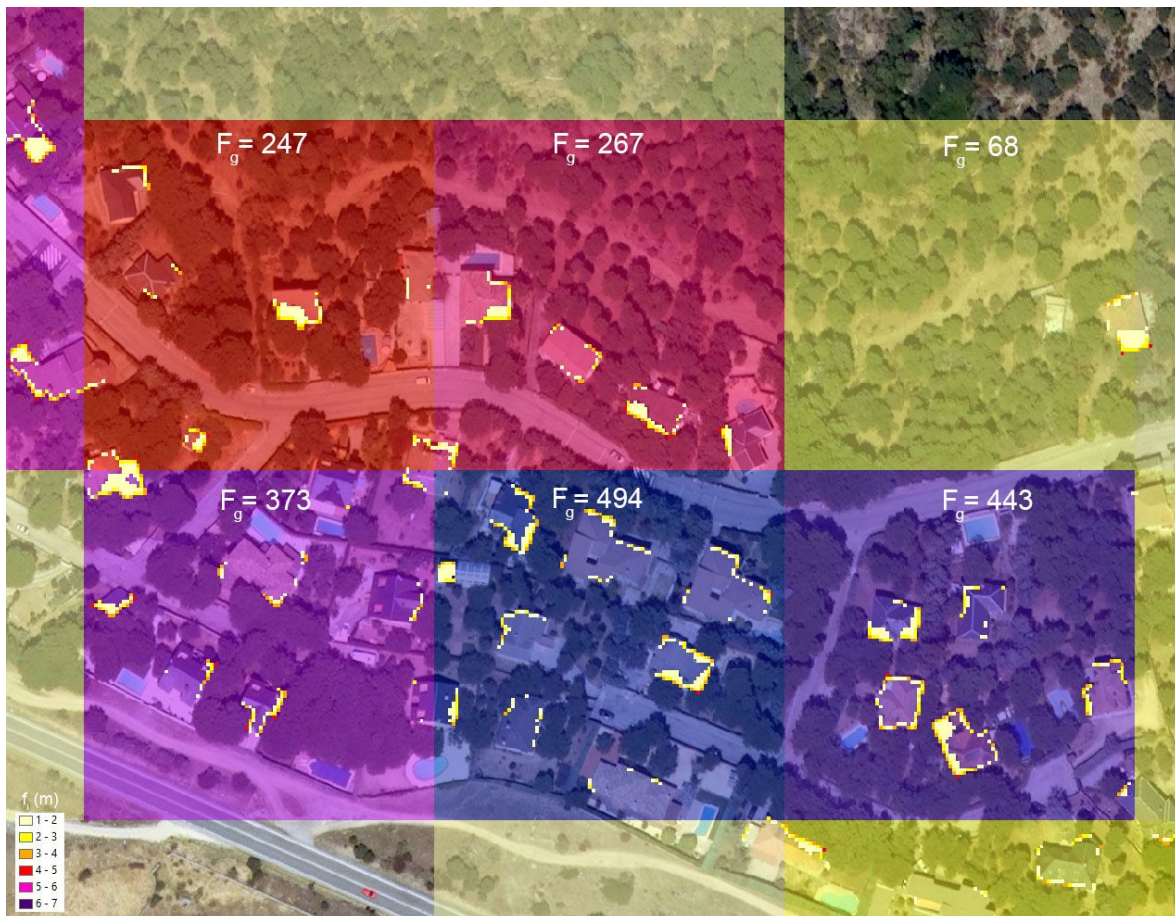
En la figura se representa la fricción total F_g (en metros) de una porción de la urbanización Puentelasierra (Madrid), para seis celdas de una hectárea cada una, y las fricciones unitarias (en metros) calculadas a 1 m de resolución. Mientras que la celda superior derecha con una casa en borde de terreno forestal tiene apenas 68 m/ha de fricción específica, la parcela inferior central acumula 494 m/ha, debida en su práctica totalidad al arbolado del jardín en 8 las edificaciones presentes.
