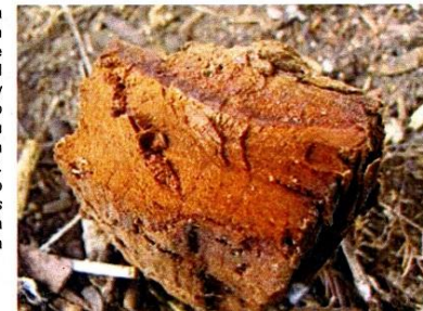
Foto 6: madera con pudrición marrón obtenida del interior del tronco
