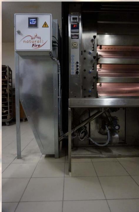
Horno de pisos. Quemador V 100
