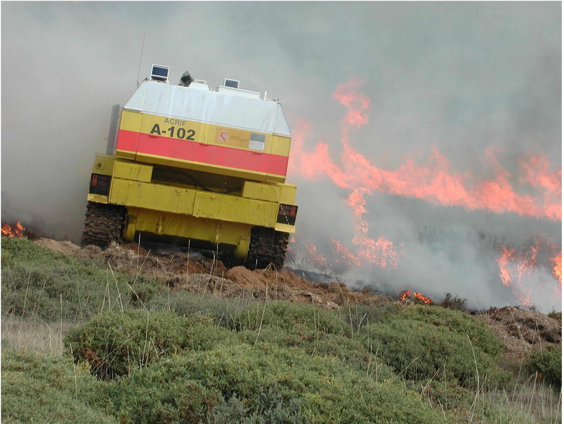
**VELIF: Chasis de AMX 58 con carga de 15.000 l agua + 500 l espumogeno. Peso Total 65.000 kgrs. Diseño de una gondola especial con todos los ejes direccionables**
