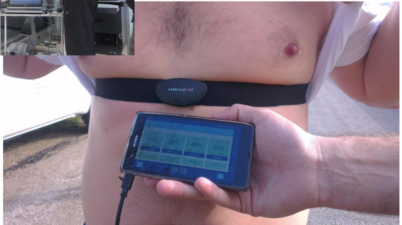
**SEGURIDAD: FIRESTRES. Control remoto del esfuerzo realizado en extinción. Conectado a Emercarto.**
